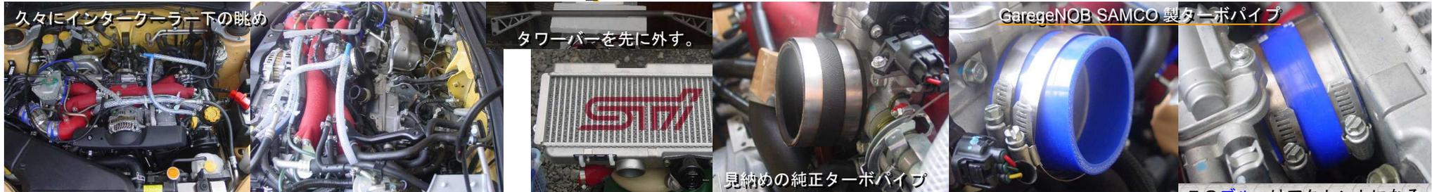
2008年2月2日 天気予報からこの週末は大荒れの天気、冷え込みも予想されたのだが、今日は曇天ながら暖かい日で、屋外の作業にはうってつけの天気となったので、10:30ごろから機械式ブースト計の取付作業を開始した。まずバキュームホースの配管作業がやりやすいように、インタークーラーを取り外した。ターボパイプは純正から既に購入済みの GaregeNOB の SAMCO 製ターボパイプに付け替えておく。外したホースの口にガムテープで蓋をする。ハイプレッシャーバイパスバルブからインマニの間のバキュームホース(φ6mm)をほぼ真真中でカットし、ブースト計用のプレッシャーを取り出すために、大森オプションパーツの3方T型ジョイントを取り付け、抜け防止にインシュロックで固定する。そこからSAMCO製バキュームホース(φ4mm)を接続してコックピットまで引き込む。バキュームホースはコルゲートチューブで保護し、その上に耐熱用のファイヤースリーブを被せて、コックピット
