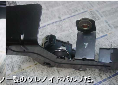
純正ソレノイドバルブのブラケットを参考に制作
