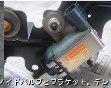
純正ソレノイドバルブのブラケットを参考に制作
