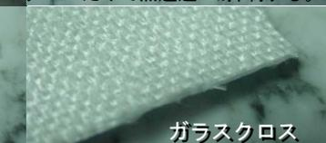
ガラスクロスだけで熱透過70%抑制する。
