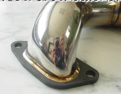
パイプとフランジの継ぎ目の段付きも丁寧に研磨して滑らかになっている。
