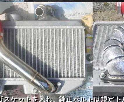
純正ガスケットを入れ、純正ボルトは規定トルク 1.6 kg/m で確実に締結する。
