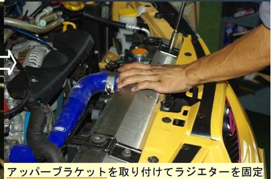
アッパーブラケットを取り付けてラジエターを固定
