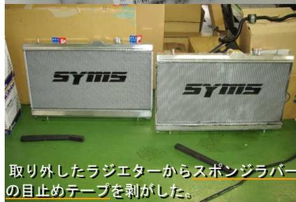
取り外したラジエターからスポンジラバーの目止めテープを剥がした。
