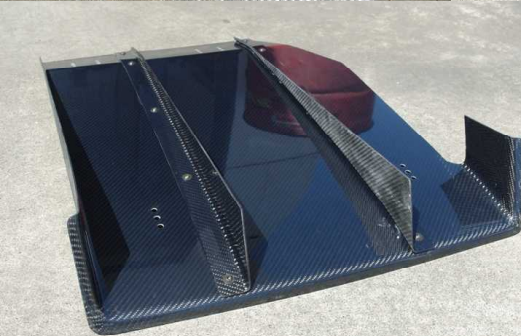
干渉部分を切断したCARBON REAR DIFFUSER
