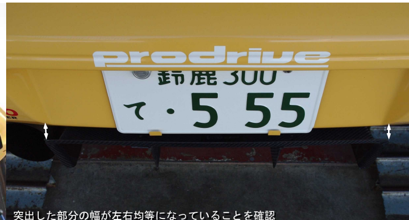
突出した部分の幅が左右均等になっていることを確認
